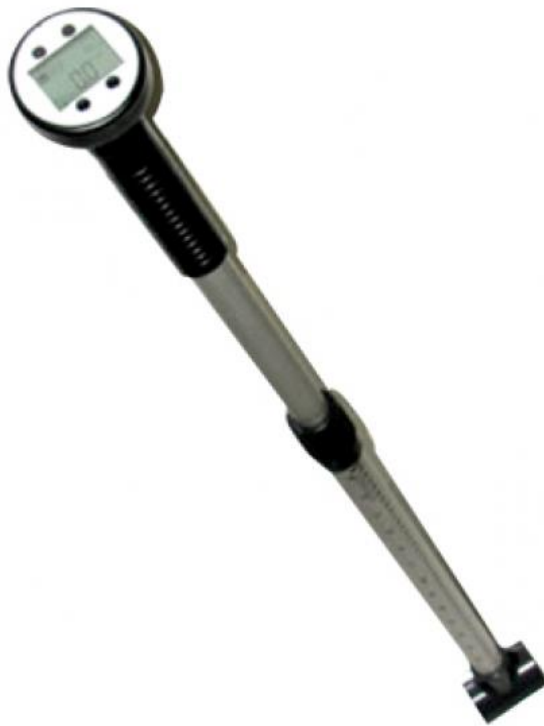
Figura 72. Molinete fluviométrico da Global Water.
