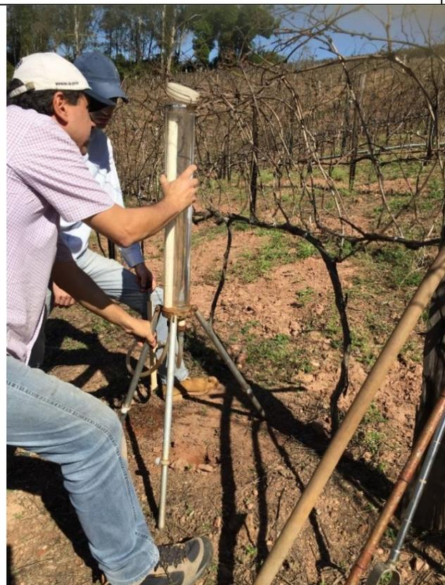
Foto 5. Determinação da condutividade hidráulica do solo em área de uva.
