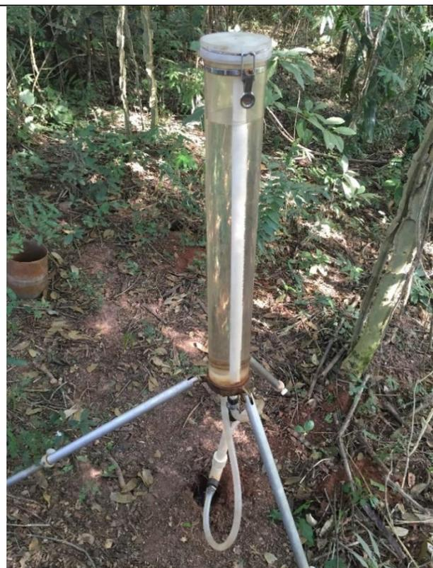
Foto 3. Determinação da condutividade hidráulica do solo em área de mata.
