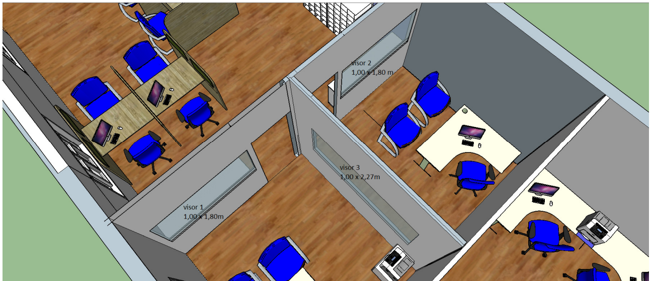
Figura 05- SALA DE CHEFE/ENCARREGADA : paredes de dry-wall e vidros a serem instalados.
