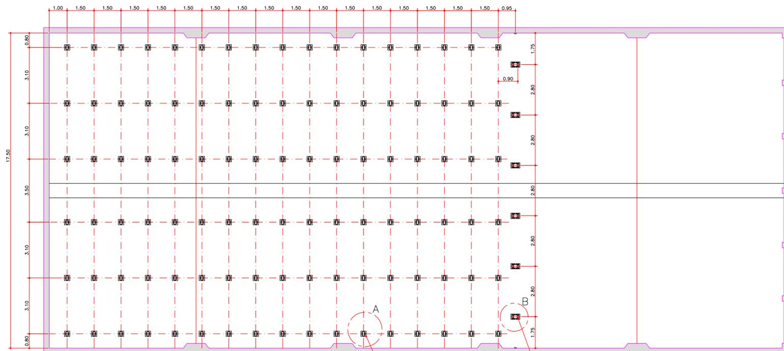
PLANTA-1 LOCALIZAÇÃO DAS COLUNAS METÁLICAS PARA MÓDULOS DE DECANTAÇÃO E CORTINA DE MADEIRA
