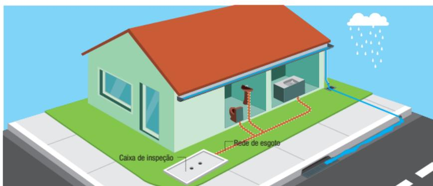
Deixe a caixa de esgoto acessível e mantenha a tampa sem lacre, facilitando manutenções e evitando danos ao piso do imóvel.
