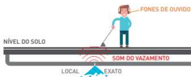
Figura 12 - Ações de caça-vazamentos
