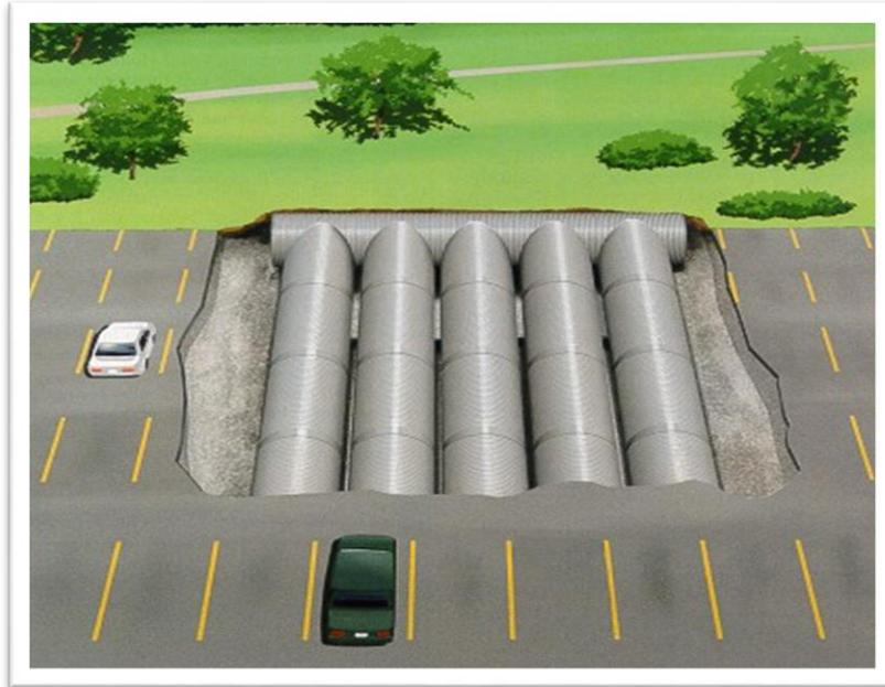
**Figura 93 – Jardim de armazenamento e infiltração.**
