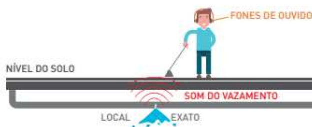
Figura 12 - Ações de caça-vazamentos
