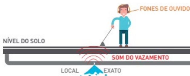
Figura 12 - Ações de caça-vazamentos
