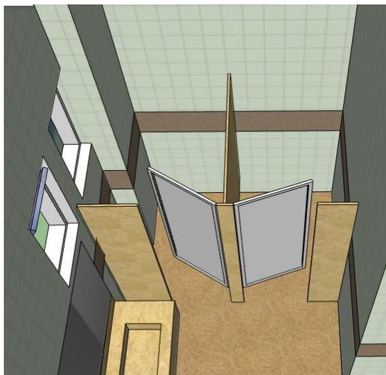
Figura 09 – ilustração das divisórias em granito
