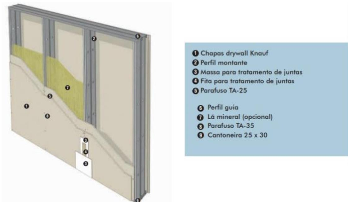
Figura 41 – Ilustração esquemática de instalação
