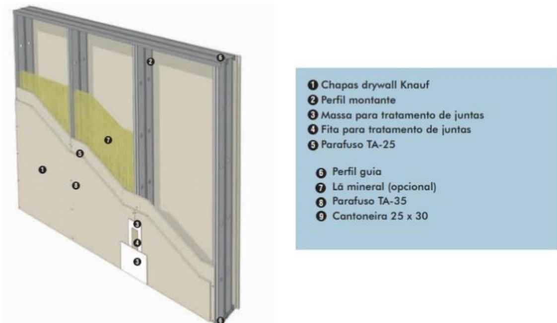
Figura 51 – Ilustração esquemática de instalação
