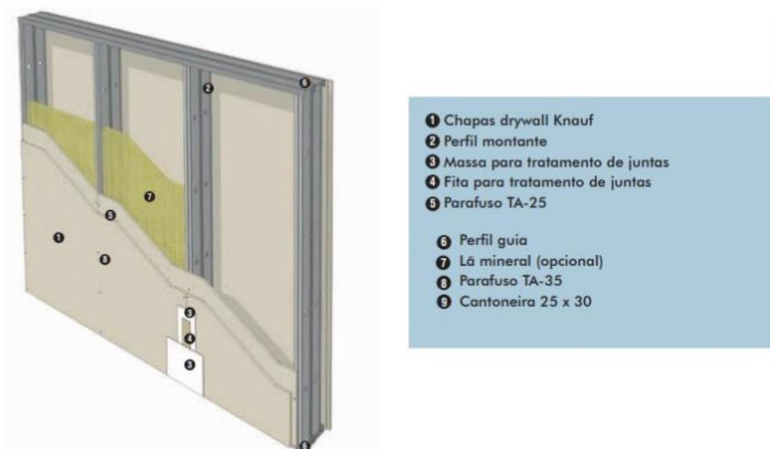
Figura 57 – Ilustração esquemática de instalação
